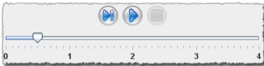
Abbildung 10: Steuerelemente vor dem Start des Debuggees: „nächster Schritt“, „Start“ und „Ablaufgeschwindigkeit“
